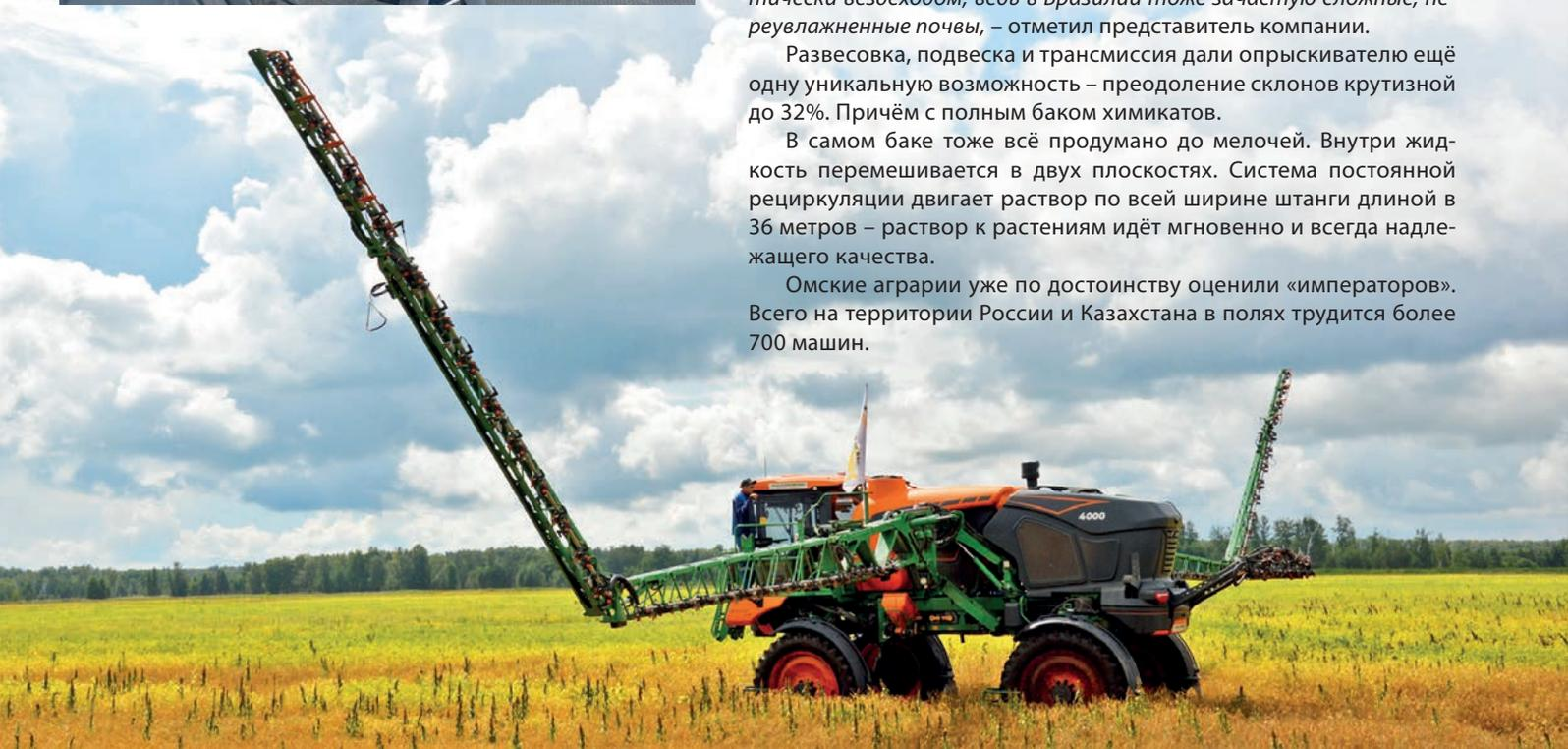
Уникальная особенность опрыскивателей IMPERADOR – это центральное расположение штанги. Конструкция опрыскивателя имеет оптимальную развесовку по осям.
