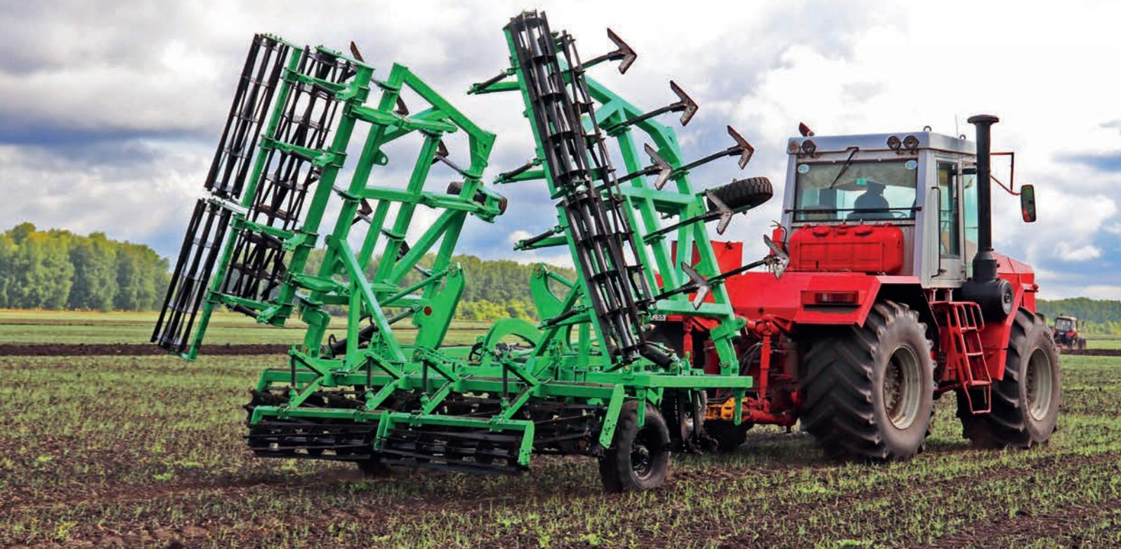
Культиваторы семейства «Степняк» предназначены для предпосевной обработки почвы, культивации паровых полей, основной обработки почвы, выравнивания поверхности поля, уничтожения сорняков, прикатывания почвы
