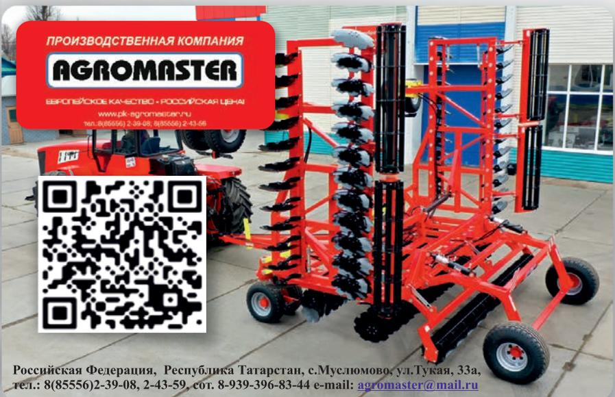
Широкозахватный дисковый агрегат для обработки почвы и стерни двумя рядами тяжелых дисков на индивидуальных поворотных стойках.
