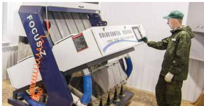
Финальная стадия очистки семян производится с использованием трех оптических сортировщиков, которые позволяют получить чистоту посевного материала 99,9%.
