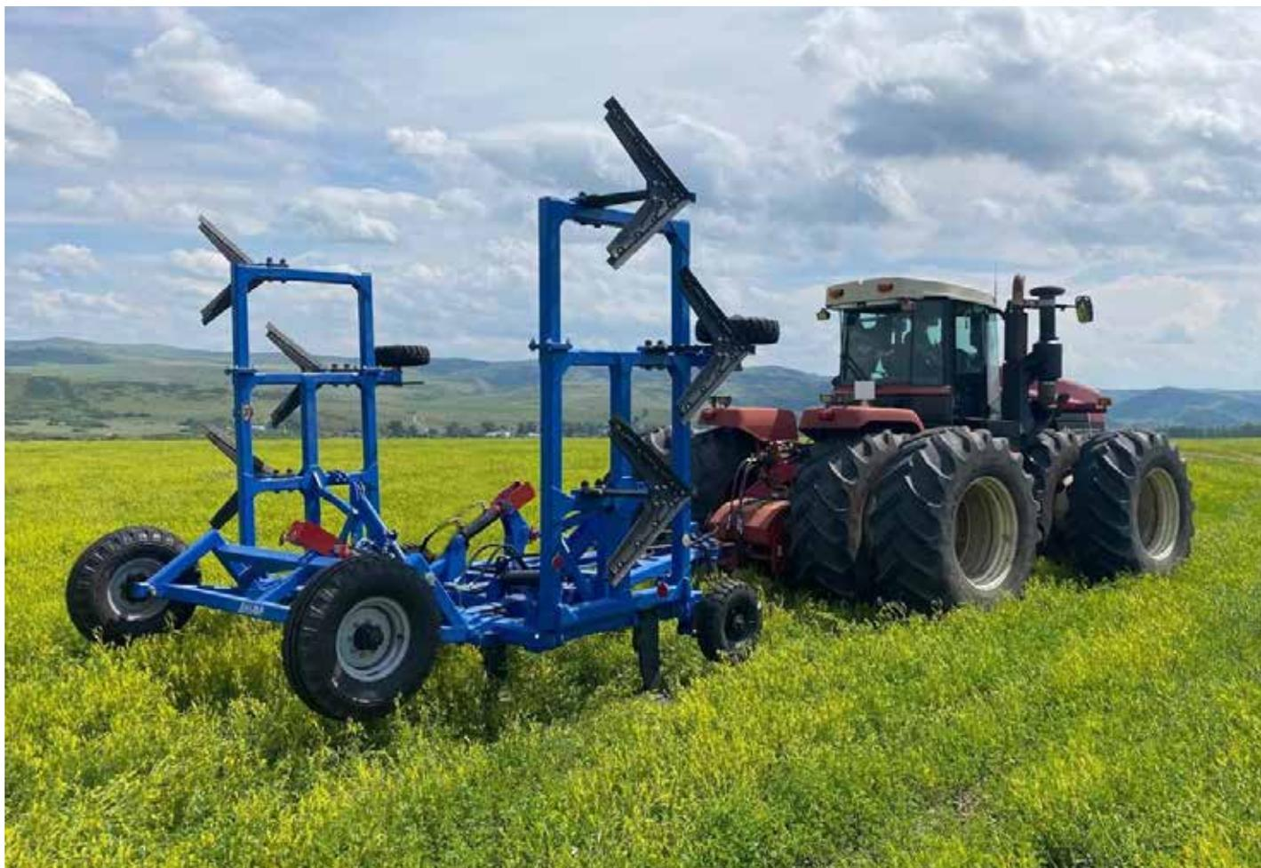
**Главный принцип работы плоскорезом – удалить сорняк, создать условия для накопления влаги в осенне-зимний период, разрыхлить твердый слой почвы и защитить ее от эрозии путем сохранения стернового покрова.**
