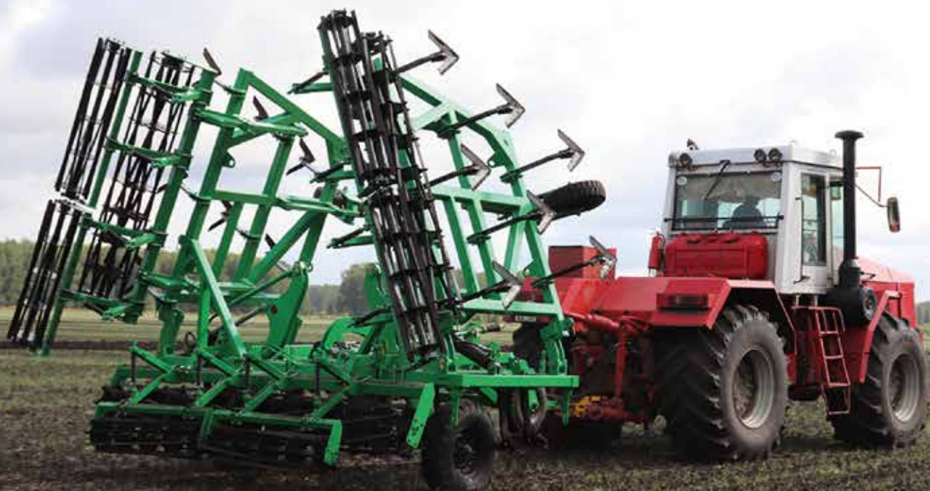
Культиватор "Степняк" с внесением удобрений КВУ-8.8 и КВУ-12.0
