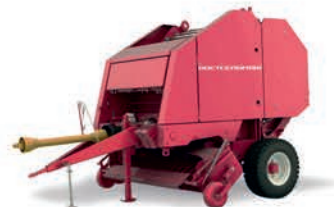
Пресс-подборщик рулонный PELIKAN MAX 1500 ширина захвата 2 м производительность до 12 т/ч
