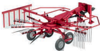
Грабли роторные навесные KOLIBRI 471 ширина захвата 4,7 м производительность до 5,6 га/ч
