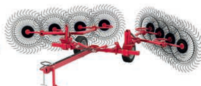
Грабли колесно-пальцевые KOLIBRI V ширина захвата 6 и 8,3 м производительность до 8 га/ч
