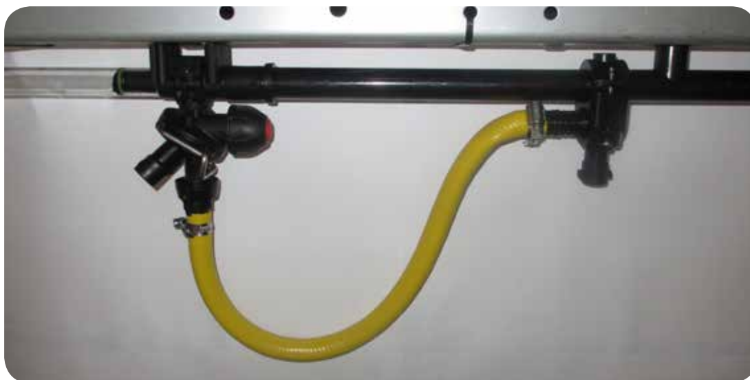
Рис. 3. Адаптер 092.174.00 для кукурузы обеспечивает смещение шланга 5S в центр междурядий на 70 см
