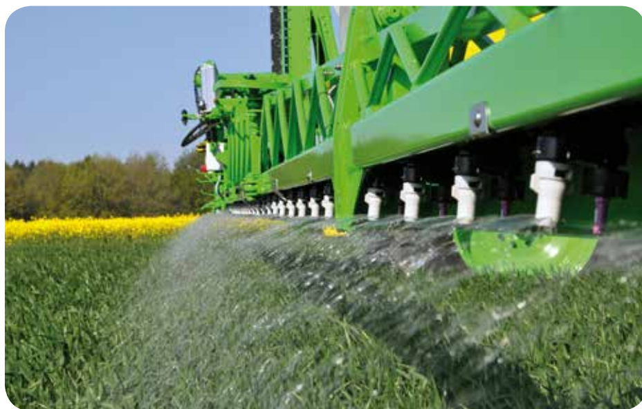
Дефлекторный распылитель FD. Внесение КАС до выхода в трубку
