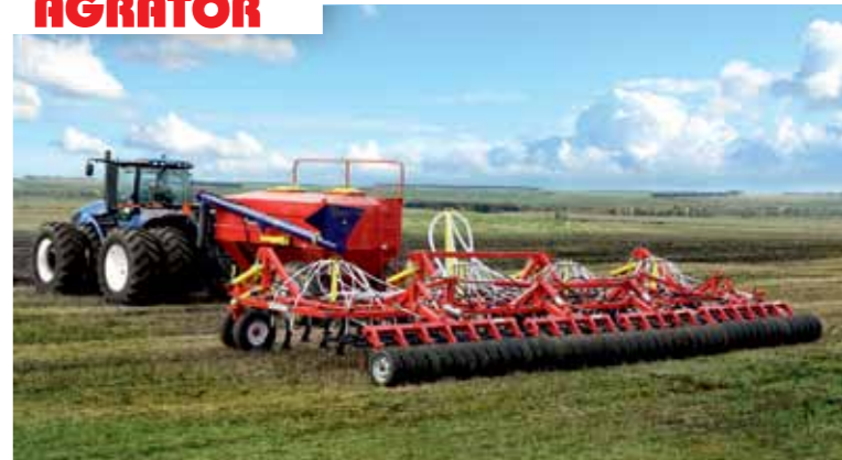
СТЕРНЕВЫЙ ШИРОКОЗАХВАТНЫЙ ПОСЕВНОЙ КОМПЛЕКС
