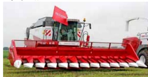
Применение ленточного транспортера на жатках FALCON позволяет более бережно относиться к транспортировке семян, а высокие борты жатки сокращают потери от самоосыпания при падении корзинок подсолнечника. Благодаря специальной форме входных каналов между лифтерами корзинок наклоняются над транспортером, и семена попадают прямо на ленту. В отличие от вибростолы, транспортер сводит к минимуму не только прямые потери, но и косвенные, связанные с травмированием семян.
