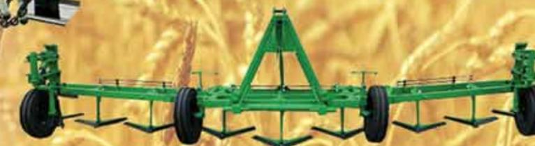
**Культиватор-плоскорез широкозахватный КПШ-9**
