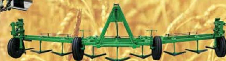
Культиватор-плоскорез широкозахватный КПШ-9
