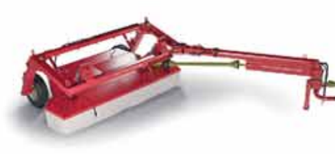
Косилка прицепная с плющильным аппаратом BERKUT 3200 ширина захвата 3,2 м производительность 4,5 га/ч
