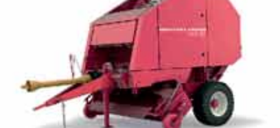
Пресс-подборщик рулонный PELIKAN MAX 1500 ширина захвата 2 м производительность до 12 т/ч
