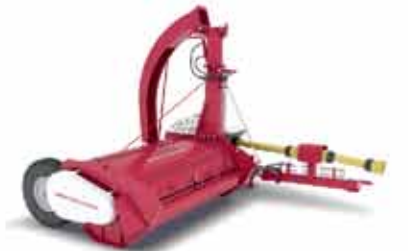
Комбайн прицепной кормоуборочный STERN 2000 производительность 38 т/ч рабочая скорость до 7,2 км/ч
