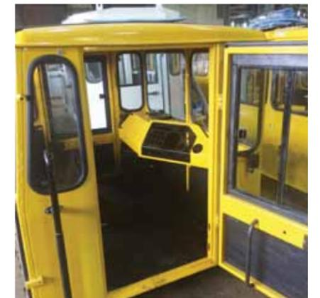
4. Модернизация кабины позволяет создать комфортные условия работы механизатора, что также является не последним фактором в производительности труда
