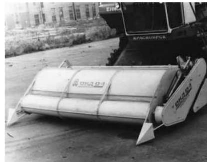
Двухбарабанное очесывающее устройство ОКД-04 предназначено для уборки зерновых, зернобобовых, крупяных культур и семенников трав методом очеса на корню. В зонах, подверженных ветровой эрозии, обеспечивает формирование стерневых кулис для снегозадержания и предотвращения выноса почвы. Обеспечивает снижение потерь при уборке полеглых и низкорослых хлебов. Устройство навешивается на комбайны семейства «Енисей» и «Нива».
