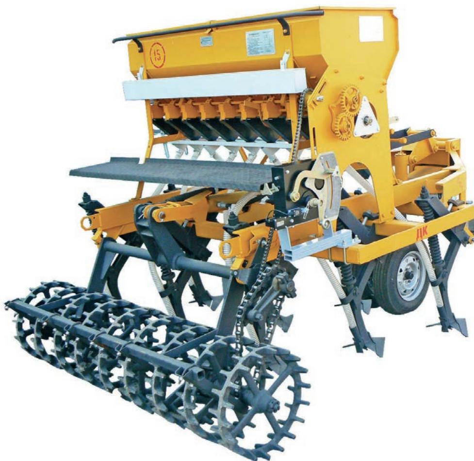
не обеспечивается стандартным зерновым высевательным аппаратом сеялки СКП-2,1 по причине одновременного воздействия многих факторов, влияющих на его работу, таких как: нестабильные настроечно-регулируемые параметры, безопорная конструкция крепления вала зерновых катушек, постоянно подклинивающие «розетки».
