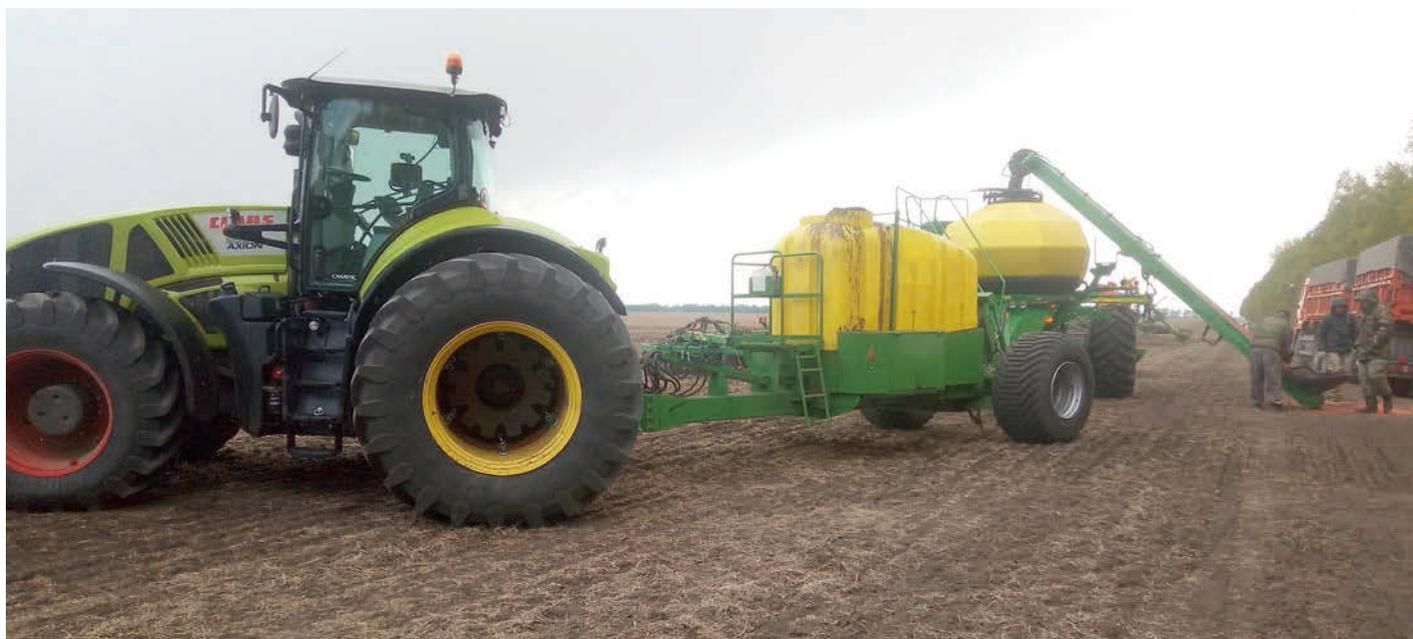
Так, совместными усилиями Алтайского ГАУ и ООО «Комплекс Агро» отработаны технологии точного позиционирования стрип-тилл и создан комплекс машин для возделывания подсолнечника и кукурузы в засушливой степи, испытания проводились на базе ООО «КХ «Партнер». Итог - экономия более чем в 2 раза затрат на почвообработку, точное внесение удобрений под будущую культуру – повышение их эффективности и увеличение урожая.
