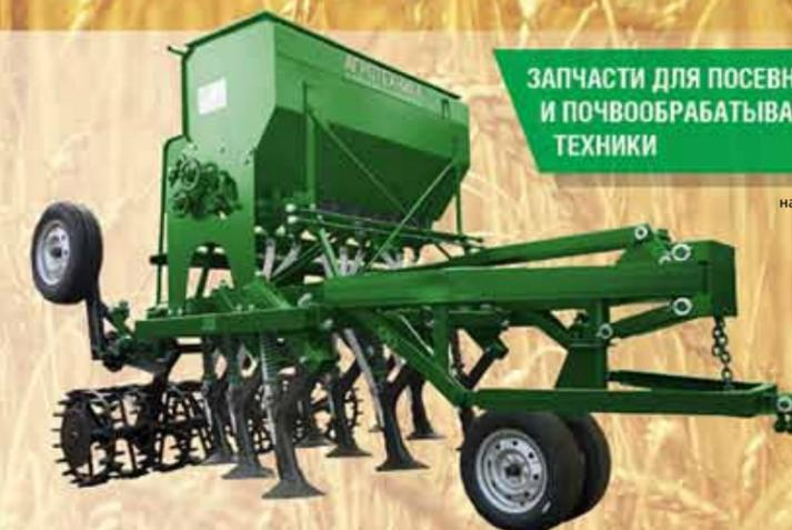
*Сеялка-культиватор зернотуковая СКП-2.1*
