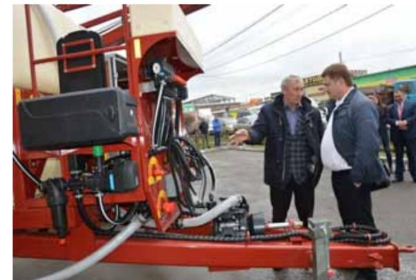
за сутки около 1200 га. Прицепные опрыскиватели RSM TS-3200 Satellite способны вносить до 500 л/га при скорости движения 12 км/ч.
