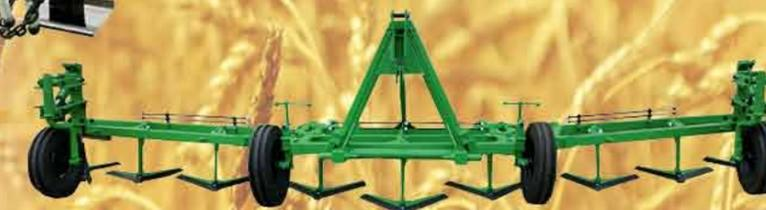
**Культиватор-плоскорез широкозахватный КПШ-9**
