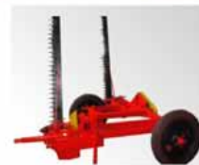
Косилка двухбрусная прицепная КД-Ф-4,0 П
