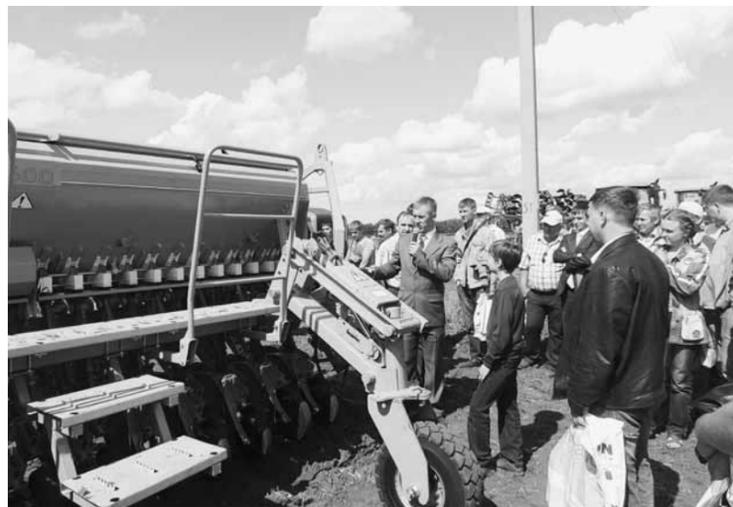
мы работаем) позволяет осуществлять очень качественный и точный посев. Сеялка может высевать от 2 до 400 кг семян на гектар. Также предусмотрена система контроля глубины заделки семян – буквально от 2 до 10 см можно задавать глубину и она будет стабильно выдерживаться, несмотря на неровности рельефа почвы.
